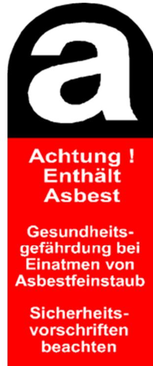
*Symbol zur Kennzeichnung asbesthaltigen Materials*
